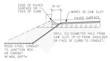
SAW SLOT EDGE OF PAVEMENT TRANSITION
